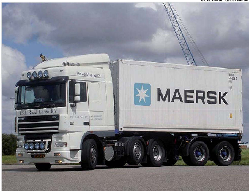
Un contenedor de ultracongelación puede mantener temperaturas de hasta 60^{\circ}\text{C} bajo cero
